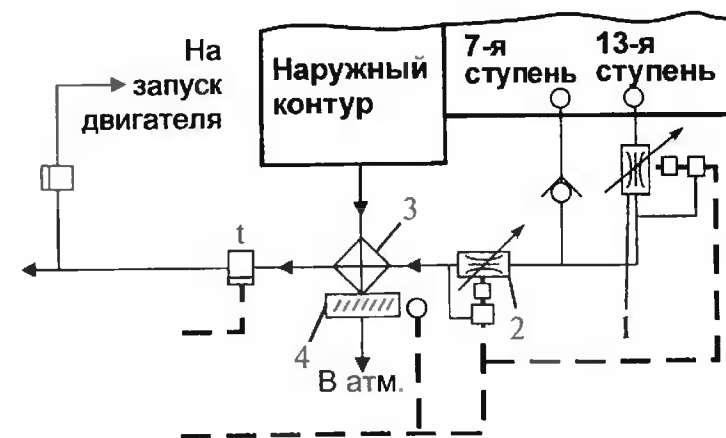
Рис. 14.6. Схема подсистемы отбора и предварительной подготовки воздуха:
