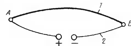
Рис. 6.7. Термоэлектрическое охлаждение: 1, 2 — проводники; А, Б — спаи
