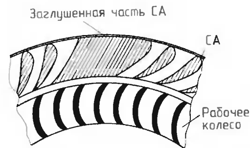
Рис. 3.9. Схема парциальной ступени турбины с заглушенной частью соплового аппарата (СА)
